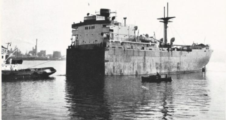
La saldatura fra i due pezzi è stata eseguita a mano con impiego di speciali elettrodi basici con una serie di operazioni successive procedendo sistematicamente secondo il seguente schema:
