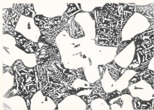
LA FASE Signa nella struttura di acciai inossidabili. La sua comparsa è indice di fragilità.
