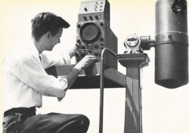
L'APPARECCHIO a raggi infrarossi Codes della ACF Industries segue anche di notte la rotazione dei satelliti lungo le loro orbite.
