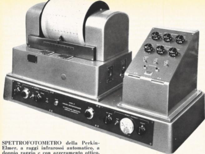
**SPETTROFOTOMETRO della Perkin-Elmer, a raggi infrarossi automatico, a doppio raggio e con azzeramento ottico.**
