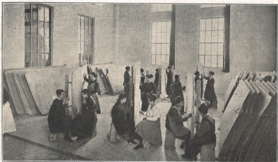
Collegamento della tela alle centine.
