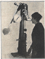
Prova dei tessuti con la macchina "Amsler".
