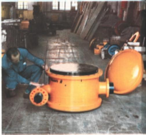
In alto a sinistra: un saldatore elettrico al lavoro. Sopra: modello di cassa d'acqua per refrigeranti destinati ai servizi della centrale termoelettrica di Napoli della «S.M.E.». In basso a sinistra: elica a tre pale, del peso di 15 tonnellate, costruita alla Fondaria. Sotto: lavorazione di una pala d'elica.
