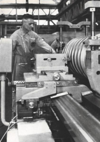
**PARTICOLARE** di un tornio per cilindri con apparecchio copiatore.
