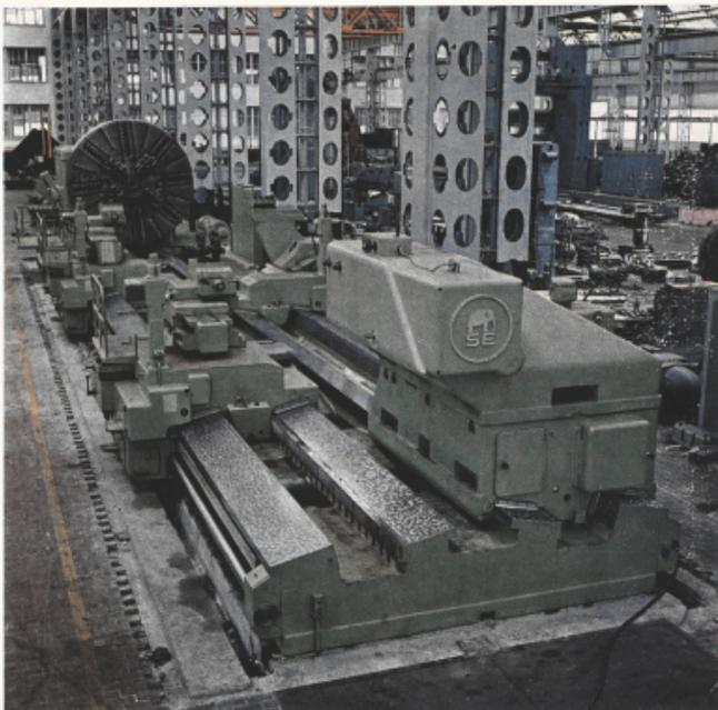
UN MODELLO di tornio parallelo pesante, per operazioni di finitura e sgrossatura.
