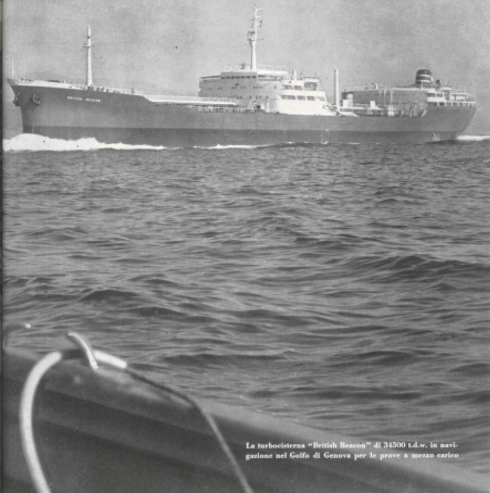
La turbocisterna "British Beacon" di 34500 t.d.w. in navigazione nel Golfo di Genova per le prove a mezzo carico
