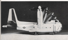
MODELLO di propulsore a ala inclinabile. Per sollevare verticalmente il propulsore può ruotare di 50 gradi fino alla posizione verticale e quindi, non appena giunto all'altezza desiderata, tornare di nuovo con le sue ali-motore alla posizione orizzontale.
