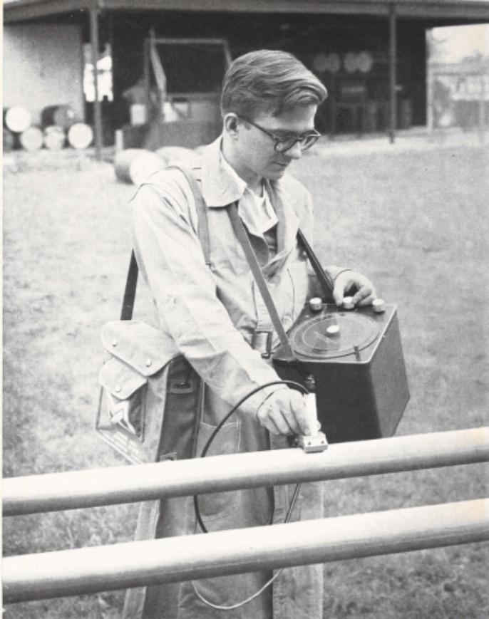
IL «SONIZON» realizzato dalla Magnaflux Corp. con la sua sonda a superficie curva di contatto per il collaudo «non distruttivo» dei tubi.
