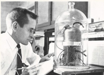
IL GENERATORE SNAP 3 DURANTE UNA PROVA DI FUNZIONAMENTO A 20 GRADI SOTTO ZERO.
