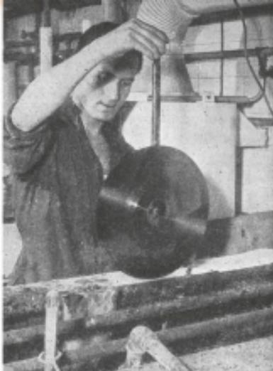
Sopra: un tecnico esamina un «master» all'uscita dalla vana. Sotto: lo operai operano il controllo visivo dei dischi finiti.
