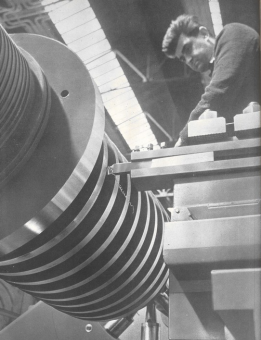
Foto di lavorazione del rotore di alta pressione per il turbocompressore da 100.000 CV, in costruzione al Biscione per la centrale "S.M.E." di Napoli
