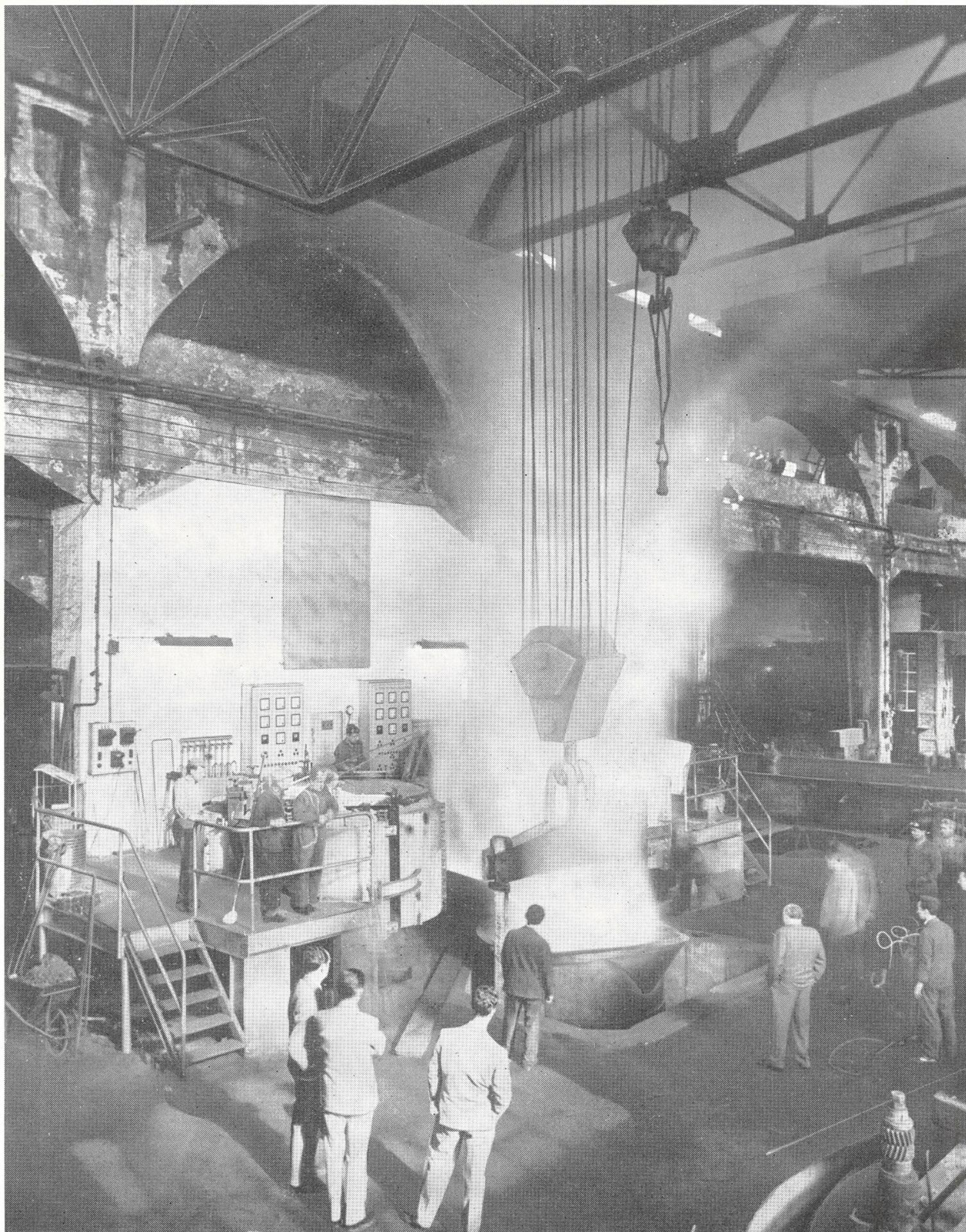
Fusione dell'elica di bronzo del peso grezzo di 45 tonn. destinata alla turbocisterna da 50.000 T.D.W. in costruzione a Sestri
