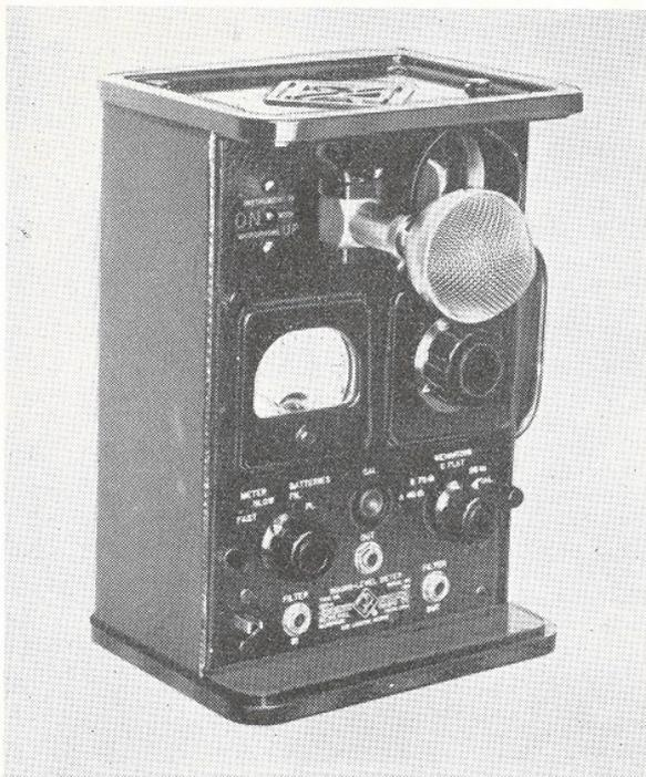
Lo strumento a microfono piezoelettrico usato per la misura dell'intensità sonora
