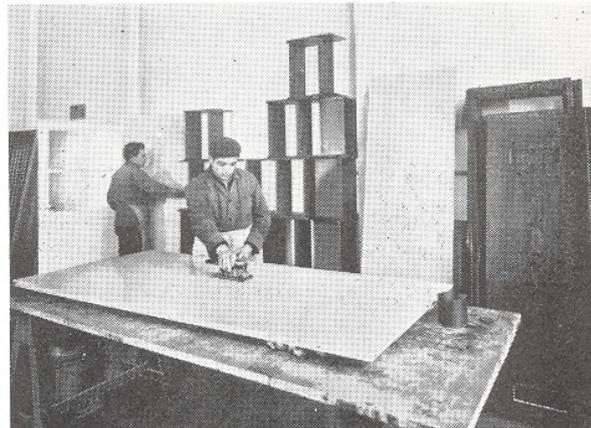
Levigatura meccanica di pannelli con macchine pneumatiche vibranti per la preparazione alla fase di lucidatura
