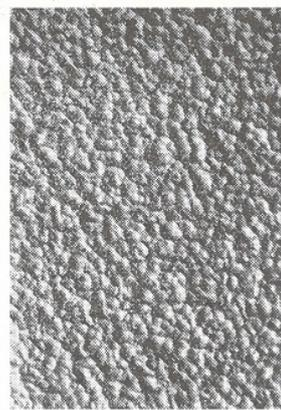
Particolare ingrandito della superficie pallinata come appare al controllo con pellicole Fax-Film
