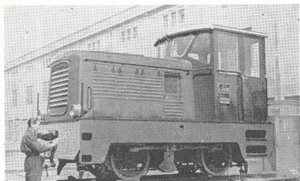
E' stata recentemente consegnata la prima delle due locomotive Diesel-idrauliche da manovra costruite dal Ferroviario per conto delle Ferrovie dello Stato e destinate in Sicilia. Le caratteristiche principali di queste locomotive sono le seguenti: potenza asse motore, HP 130; peso in servizio, tonn. 20; scartamento, mm. 950; due assi; sforzo massimo di trazione kg. 5300; motore Diesel Deutr, cambio idraulico Voith
