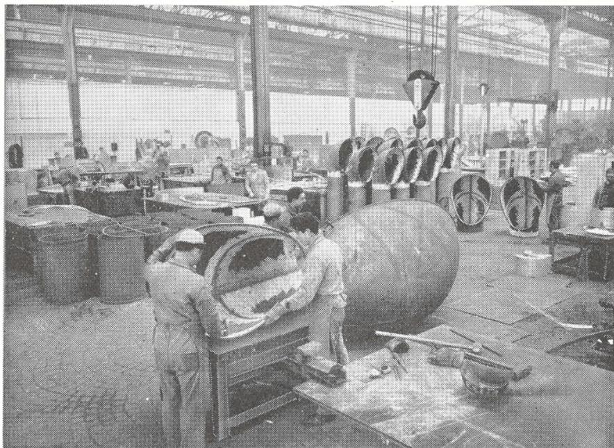
Costruzione, all'Officina carpenteria leggera del Cantiere di Sestri, di trombe a vento destinate a tre motonavi da carico di 10670 T.D.W. della « Villain & Fassio » di Genova.
