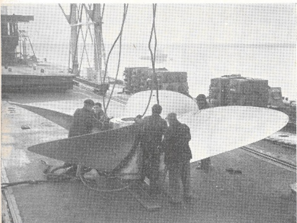
Sollevamento di un'elica di bronzo al manganese, del peso di circa 21 tonnellate, per la sistemazione su una turbocisterna di 15.500 tonnellate di portata lorda.
