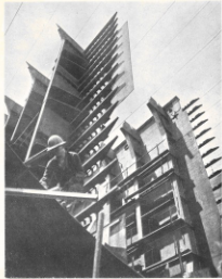
Scene di lavoro al Cantiere di Sestri. Sopra a sinistra: blocco di prua prefabbricato della torpediniera «British Signet» di 36300 t.d.w. in procinto di essere trasportato a bordo. Sopra a destra: particolare di una torpediniera di 32.300 t.d.w. in costruzione. Sotto: imbarco di una turbina per la «Leonardo da Vinci».
