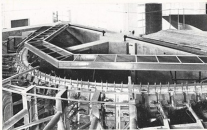
MODELLO OSCOLA 1, AGO DELLA MIRA BORDO IN LUI PONTERRA - VISTA CENTRALE DEL PARABOLICO DA BORDO CON L'ATTREZZATURA PER IL CARICO ISOSTATICO.
