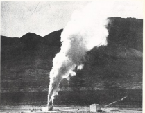
LA NUBE DI IDROGENO DEL « Keri-A », DURANTE I CONTROLLI DELLA RADIOPROTEZIONE CREATA DAL REATTORE NELL'AMBIENTE CIRCOSTANTE. A SINISTRA: UN ESPERIMENTO RADIOMETRICO A TERRA FINO AD ORENTA.
