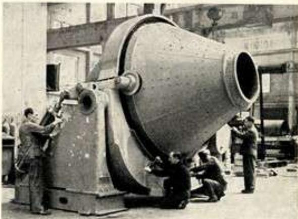
Una nuova betoniera di grande capacità è stata costruita dal MEF. Ha le seguenti caratteristiche: capacità: 3 mc.; peso del bicchiere: circa 7 tonn.; peso totale: 16 tonn.; diametro della corona dentata: m. 3; comando pneumatico del ribaltamento; comando della rotazione con motore elettrico da 70 HP; giri del bicchiere al minuto primo: circa 10.
