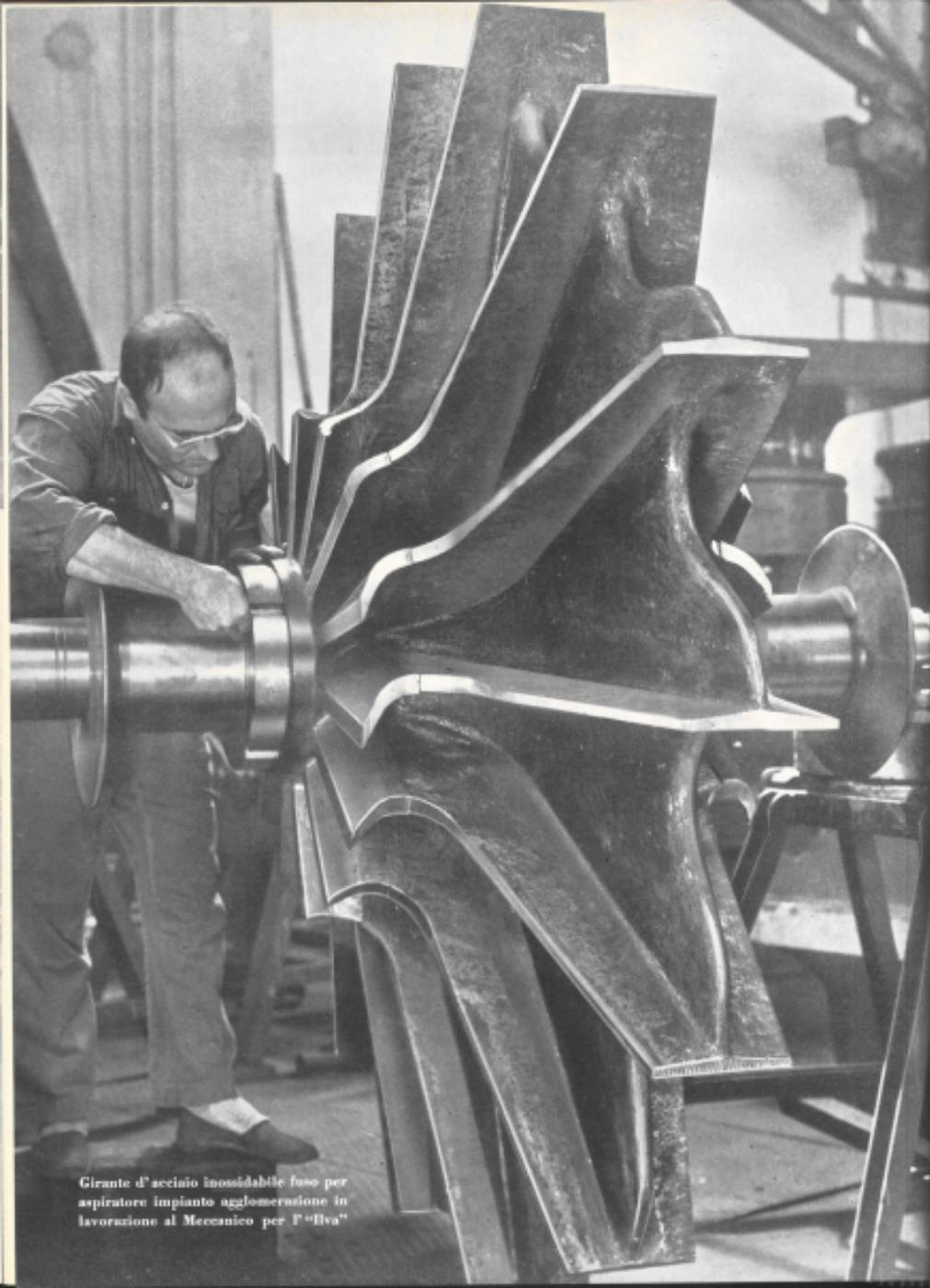
Girante d'acciaio inossidabile fuso per aspiratore impianto agglomerazione in lavorazione al Meccanico per l'"Ilva"
